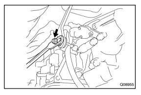
7. DISCONNECT TRANSMISSION CONTROL ROD FROM SHIFT LEVER
