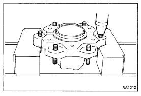
(d) Using a press, press out the hub bolt.
