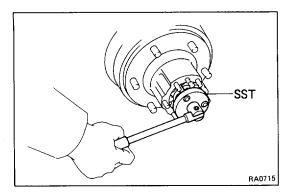
(d) Using SST, retighten the bearing lock nut.
