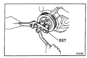
(d) Using SST, remove the pulley. SST 09213–31021
