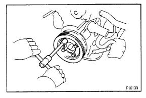
21. REMOVE CRANKSHAFT PULLEY
