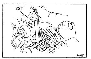
(d) Using SST, install the pulley bolt. SST 09278–54012 Torque: 108 N-m (1,100 kgf-cm, 80 ft-lbf)
